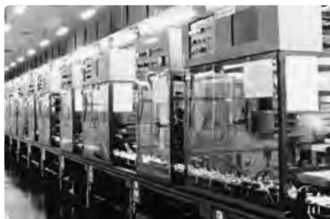
[5] VTRの量産製造ラインと組み立てられた機構部
