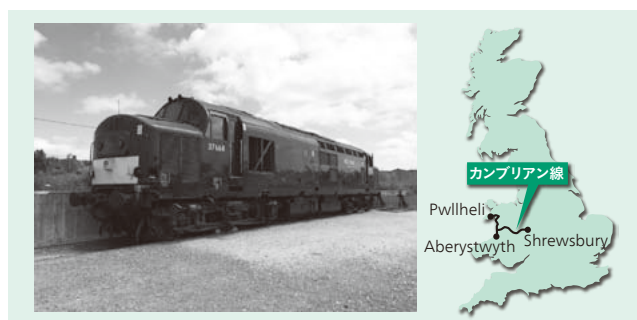
図1 | 日立製ETCS車上装置を搭載したClass37機関車とカンブリアン線略図
