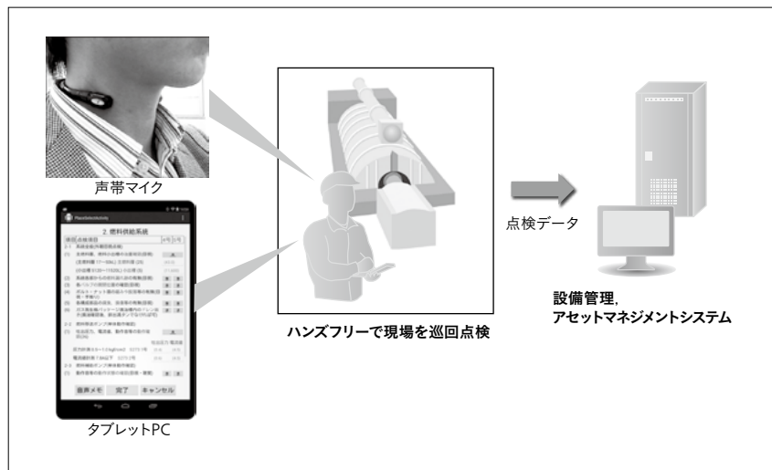
図7 ハンズフリー点検支援システムの構成
