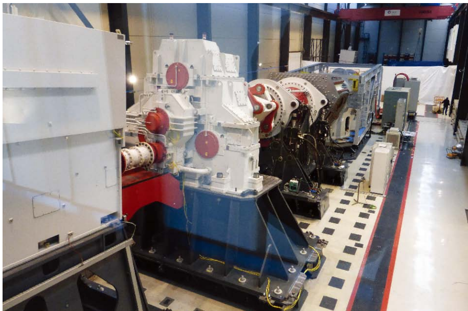
1 ナセル耐久試験の全景
