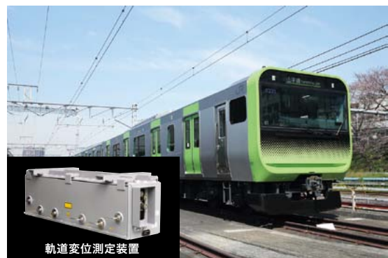
3 東日本旅客鉄道向け営業車搭載型軌道変位測定装置
