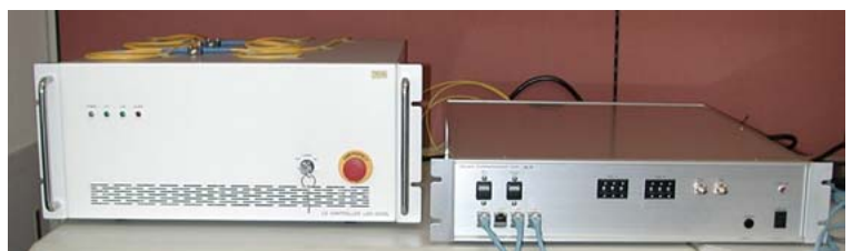
2 試作した暗号通信装置本体 (右) およびノイズ発生部 (左)
