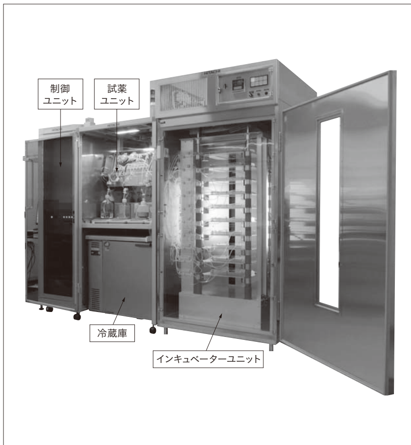
図2 | iPS細胞大量自動培養装置(iACE1)
